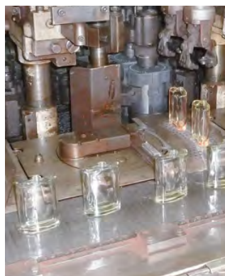
Version spéciale pour petites pièces en verre Chaîne de convoyage silencieuse configurée pour la ligne de production de flacons.
