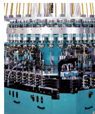
Verre pour le médical Dans un tour à façonner pour l'usinage du verre brut, les 32 moules sont tournés simultanément par une seule chaîne dentée Biflex.
