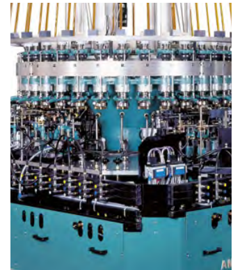
Medizinglas In einer Formendrehmaschine für Rohrglasweiterverarbeitung werden mit einer einzelnen Biflexzahnkette alle 32 Formen synchron gedreht.
