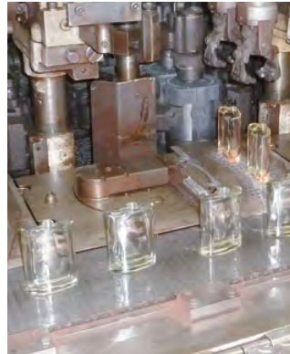
Spezialausführung für Kleinstglas Individuell angepasste Transportzahnketten für die Herstellungslinie von Flakons.
