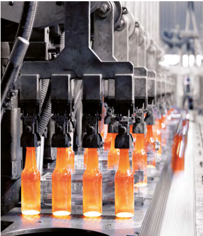
Das Maschinenband an IS-Maschinen in der Hohlglasproduktion übernimmt die Rohlinge und transportiert sie zum Umsetzer
