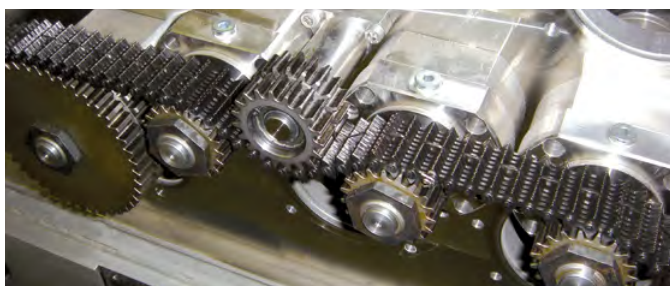
Biflex-Zahnketten. Walzenantriebe mit spezialbeschichteten Zahnketten zum Einsatz im Vakuum
